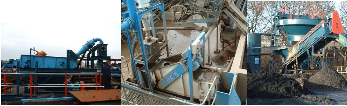
הפרדת חול הידרוציקלון הפרדת חול ממים שטיפת חול והפרדת דקים הפרדת חול
