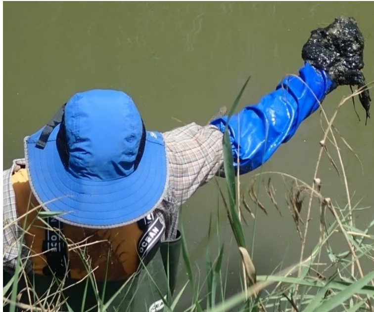
תמונה א2: תשתית מקטע מורד מט"ש עפולה – בוצה שחורה ודביקה
